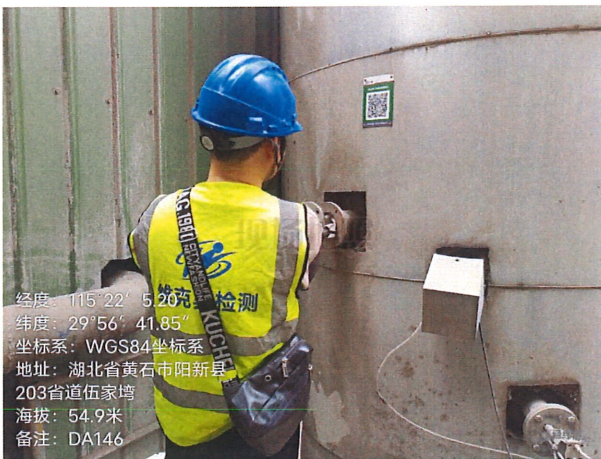
2#水泥磨辊压机排放口 DA146# 有组织排放废气检测点位
